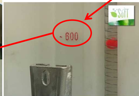
INDICATORE DEL LIVELLO sul serbatoio
